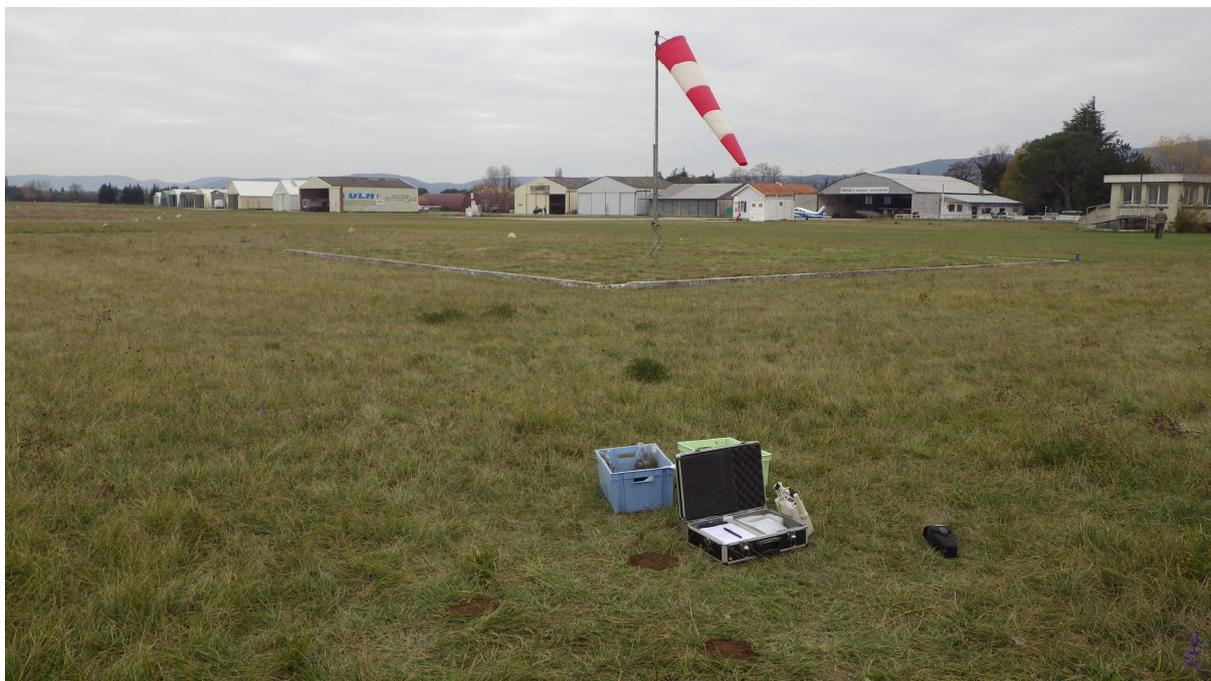
**Photo 2 : Prélèvement d'herbe avant le prélèvement des 2 horizons de surface**
